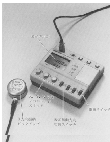
図 振動レベル計と振動ピックアップ（出典：参考文献 [2], p.152）
