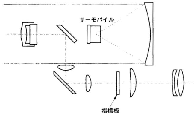
図 今回の測定で使用する放射温度計の光学系（出典：参考文献 [ 5 ], p.37）
