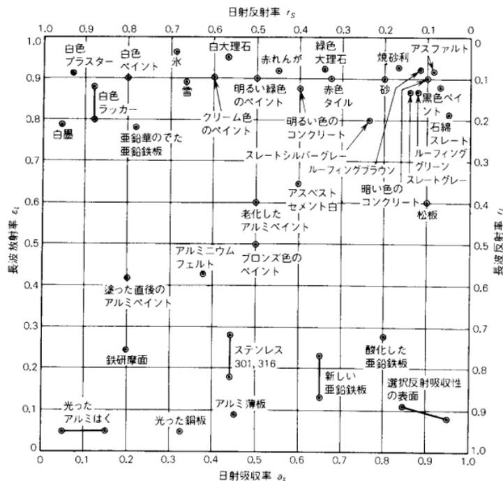
図 材料表面の日射吸収率および長波放射率（出典：参考文献 [ 4 ], p.122）
