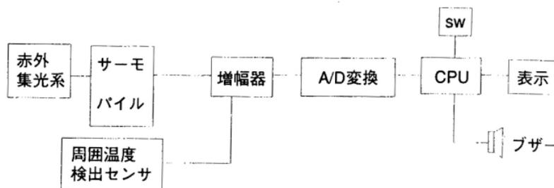
図 今回の測定で使用する放射温度計の測定原理を示すブロック図(出典:参考文献[5], p.36)
