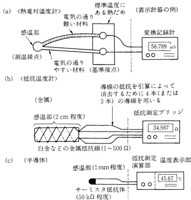
図 電気式温度計の感温部（出典：参考文献 [ 3 ], p.90）
