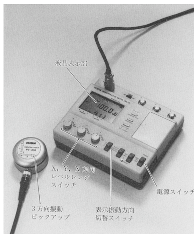
図 振動レベル計と振動ピックアップ（出典：参考文献 [2]，p. 152）
