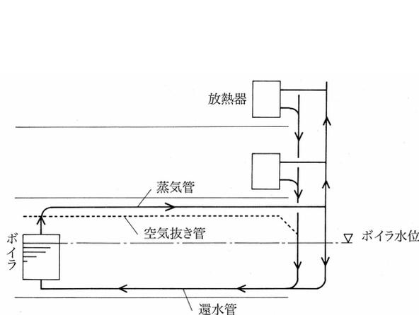
ケルチング式蒸気暖房の模式図
